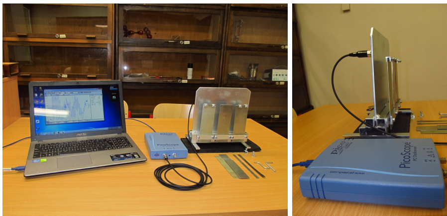
Obr. 5: Počítač s USB osciloskopom a vibračná skrinka. Bočný pohľad na zostavu, na zadnej strane rezonančnej dosky vidieť uchytenú vibračnú sondu.
